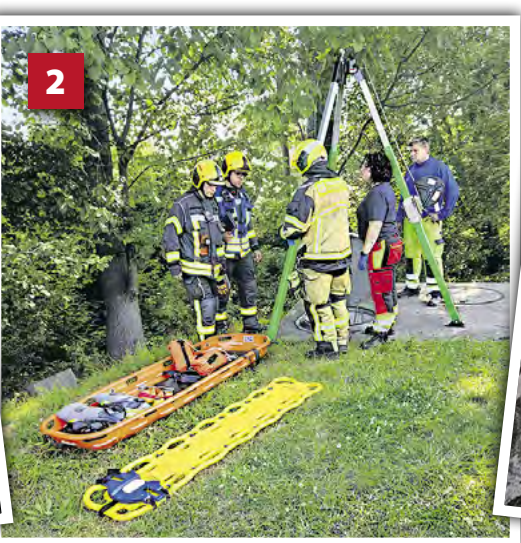
Überirdische Vorbereitung: Ein Dreibock mit Personenwinde und Höhensicherungsgerät wurde aufgebaut sowie die Luftqualität im Arbeitsbereich gemessen, um die Sicherheit zu gewährleisten. Der Zugang wurde mittels Begehungsschein genehmigt.
