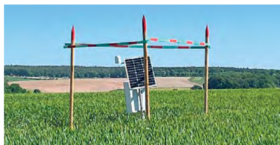
Beispiel für eine Bodenfeuchtemessstation: Das Foto zeigt den Messplatz in Eineborn im Südosten des Saale-Holzland-Kreises.
