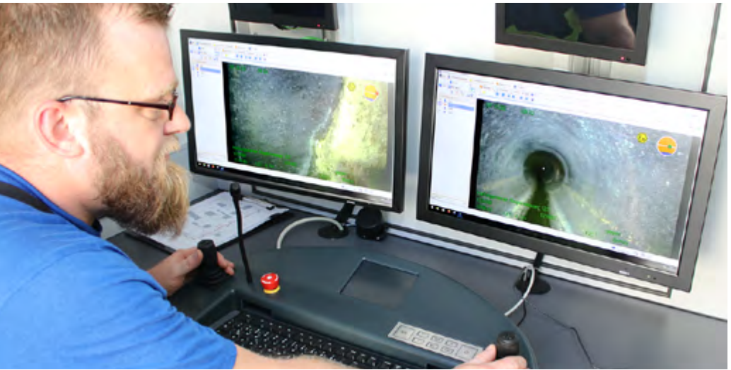
Mobiles Büro: Kanalinspekteur Ralf Rutz kann gleich vor Ort die Kamerabilder auswerten und bei Schäden die Kollegen informieren.
